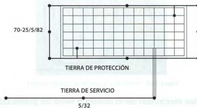
Figura 2.42. Sistemas de puesta a tierra en un CT en edificio aislado prefabricado, junto con el armado de la solera del piso del CT.
