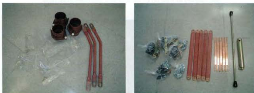
Figura 2.50. Materiales para el montaje de un CT de abonado con fines didácticos.
