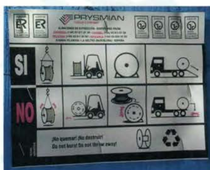
Figura 3.22. Etiqueta de precauciones en la manipulación de las bobinas.
