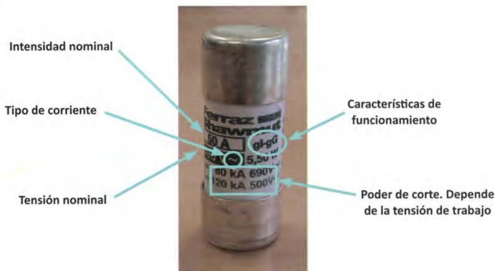
Figura 6.16. Parámetros característicos de un fusible.
