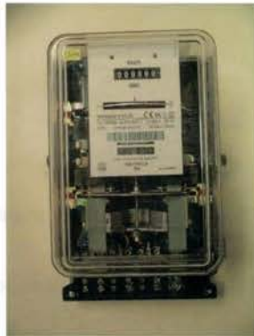
Contador trifásico de inducción
