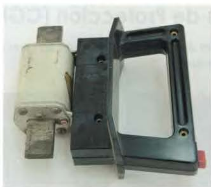
Figura 6.7. Herramienta para la extracción de fusibles de cuchillas o de las conexiones amovibles de los neutros en las CGP.
