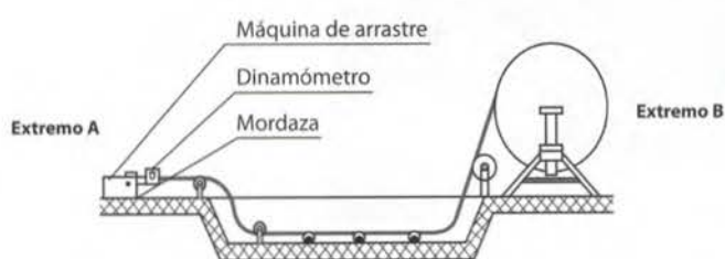
Figura 4.23. Proceso de tendido con ayuda de cabestrante.
